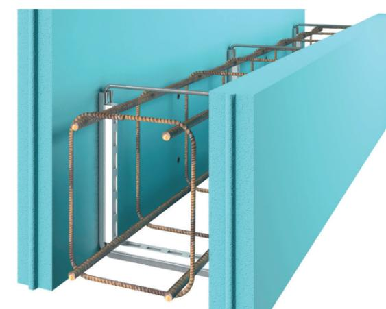
Die MAKOTHERM Fundamentalschalung ist die erste Wahl für Niedrigenergie- und Passivhäuser. Die Verarbeitung ist denkbar einfach: Die Befestigung der U-Bügel an den extrudierten Polystyrol-Hartschaumplatten (XPS) erfolgt über vormontierte Spezialdübel, welche eine bedarfsgerechte, flexible Beabstandung ermöglichen. Zusätzliche Eckelemente sind daher bei dieser durchdachten Fundamentalschalung nicht erforderlich. **MAKO und der Vorsprung bleibt!**
