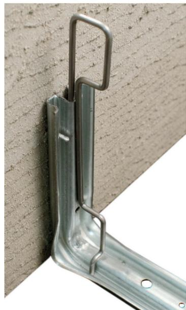
Die **MAKOSTECKBÜGEL** sind mit einer non-twisting-Funktion ausgestattet, wodurch die Bügel fest und ohne Drehbewegung gehalten werden. Durch diesen Effekt ist es möglich, die nach DIN 1045 vorgeschriebenen Stabstähle exakt zu positionieren.
