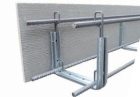
3 Letztendlich werden die oberen Stabstähle in die Öffnungen der Steckbügel eingeschoben. Die Bewehrung für Ringanker, die Teil des Deckensystems sind, ist fertig
