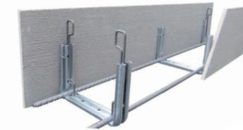
2 Die Steckbügel aus verzinktem Spezialdraht werden jeweils in die gegenüberliegenden Öffnungen der profilierten U-Bügel geschoben (zwei Stück pro Element), wodurch die beiden unteren Stabstähle fest und geradlinig fixiert werden
