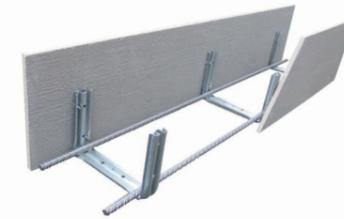
1 Die **MAKORING-TOP** Schalung auf dem Mauerwerk ausrichten und fest verankern. Unter Berücksichtigung der DIN EN 1992/NA werden die beiden unteren Stabstähle in der inneren linken und rechten Ecke der Schalung eingebracht
