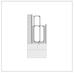
2. Bewehrungskorb und Armierungseisen unter Berücksichtigung der DIN EN 1992/NA
