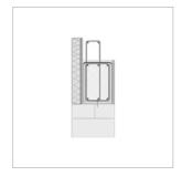
3. Rundstahlklammern zur Abspannung einsetzen, Schalung prüfen und ggf. weitere Sicherungsmaßnahmen durchführen und anschließend bis zum Deckenauf-
