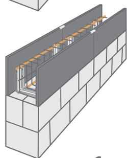
2 Zugstangen einwerfen und einbauen – zwei im unteren und eine im oberen Eckbereich – und mit dem Bewehrungskorb fest verbinden
