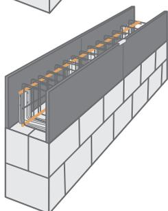
4 Vierte Zugstange im Eckbereich vom Stecker (Kappe) befestigen und anschließend betonieren
