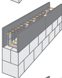
3 Offene Bügelbewehrung mit Steckern (Kappen) – gemäß DIN 1045-1:2008-08 Abschnitt 12.7 – schließen
