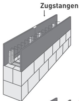
1 Schalungselemente auf dem Mauerwerk aufsetzen, dicht aneinander stoßen lassen und durch Elementausrichter auf dem Mauerwerk fixieren
