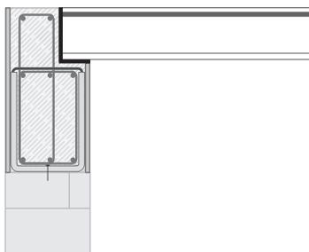
4. Spannbeton-Fertigdecke sicher verlegen und Ortbeton bis Oberkante Deckenrand in vorgeschriebener Güte und Konsistenz einbringen und verdichten
