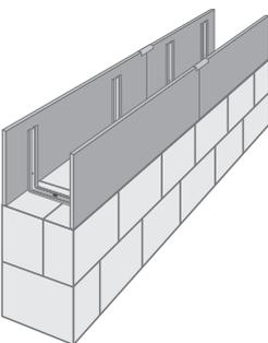
2 Schalung durch Nägel oder Schrauben fest mit dem Mauerwerk verbinden, bei Porotonsteinen Elementausrichter verwenden
