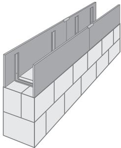
1 Schalungselemente auf dem aufgehenden Mauerwerk aufsetzen und dicht aneinander stoßen lassen
