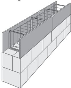
4 Rundstahlklammern zur oberen Abspannung einsetzen, Schalung prüfen und ggf. weitere Sicherungsmaßnahmen durchführen, anschließend betonieren
