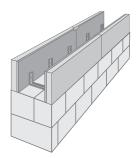
Schalungselemente auf dem aufgehenden Mauerwerk aufsetzen und dicht aneinander stoßen lassen
