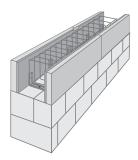
3 Bewehrungskorb unter Berücksichtigung der DIN EN 1992/NA einbauen und anschließend betonieren
