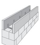
2 Schalung durch Nägel oder Schrauben fest mit dem Mauerwerk verbinden, bei Porotonsteinen Einkomponenten-PUR-Klebstoff verwenden
