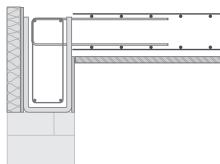
2 Bewehrungskorb unter Berücksichtigung der DIN EN 1992/NA einbauen und erforderliche Deckenarmierung einbinden
