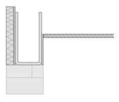
1 Schalungselemente aufsetzen, dicht aneinander stoßen lassen und fest durch Nageln oder Schrauben verankern, bei Porotonsteinen Elementausrichter sowie Einkomponenten-PUR-Klebstoff verwenden
