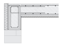
3 Rundstahlklammern zur oberen Abspannung einsetzen, Schalung prüfen und ggf. weitere Sicherungsmaßnahmen durchführen, an-schließend betonieren
