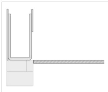
1. Schalungselemente auf dem aufgehenden Mauerwerk aufsetzen, dicht aneinanderstoßen lassen und fest durch Nageln oder Schrauben verankern
