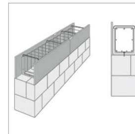
4. Rundstahlklammern zur oberen Abspannung einsetzen, Schalung prüfen und ggf. weitere Sicherungsmaßnahmen durchführen, anschließend betonieren.
