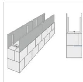
2. Schalung durch Nägel oder Schrauben fest mit dem Mauerwerk verbinden, bei Porotonsteinen Elementausrichter verwenden.
