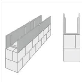
1. Schalungselemente auf dem aufgehenden Mauerwerk aufsetzen und dicht aneinander stoßen lassen.
